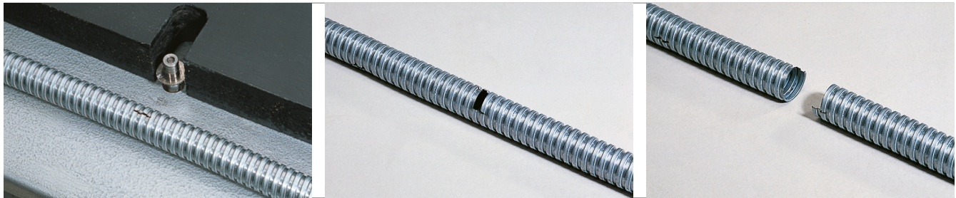
Trennschnitt in Längsrichtung des Schlauches über 1 bis 2 Schlauchgänge Cut longitudinally across 2 hose covering segments
